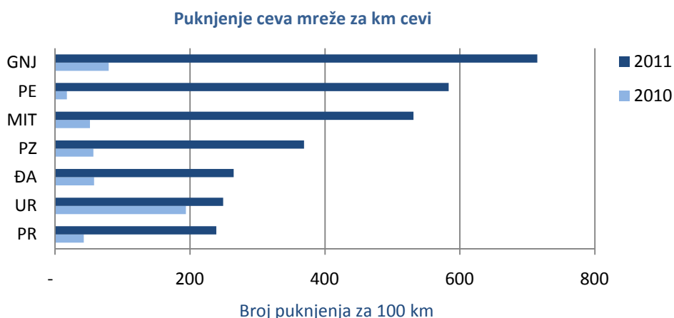
Slika A-4, Pukotine cevi vodovoda
